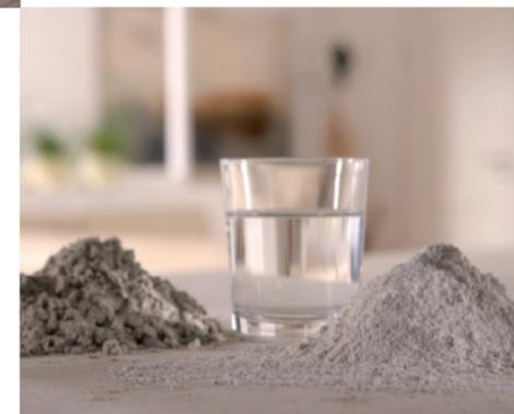
L'obbligo relativo alla genuinità dei prodotti FERMACELL è un aspetto molto importante: per produrre le lastre in gessofibra FERMACELL vengono impiegati esclusivamente materiali naturali. Essi consistono in carta riciclata, gesso ed acqua che, sottoposti ad alta pressione, si compattano fino a formare lastre stabili ed inodori.
