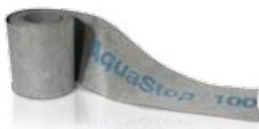
**NASTRO IMPERMEABILE ELASTICO IN POLIETILENE RIVESTITO SU AMBO I LATI DA POLIPROPILENE NON TESSUTO AD ELEVATA ADESIONE PER GIUNTI PERIMETRALI E DI FRAZIONAMENTO-DILATAZIONE DA APPLICARE CON ECO-ADESIVI DELLA LINEA H40®.**
